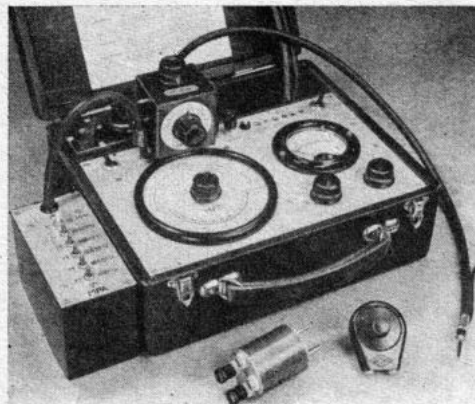
Bild 1. Das MPA-Gerät (Meß-, Prüf- und Abgleich-Gerät) mit sämtlichem Zubehör
